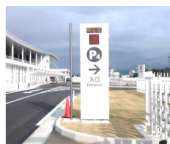
案内表示部：160mm角 3桁表示 320mm角 1桁表示
